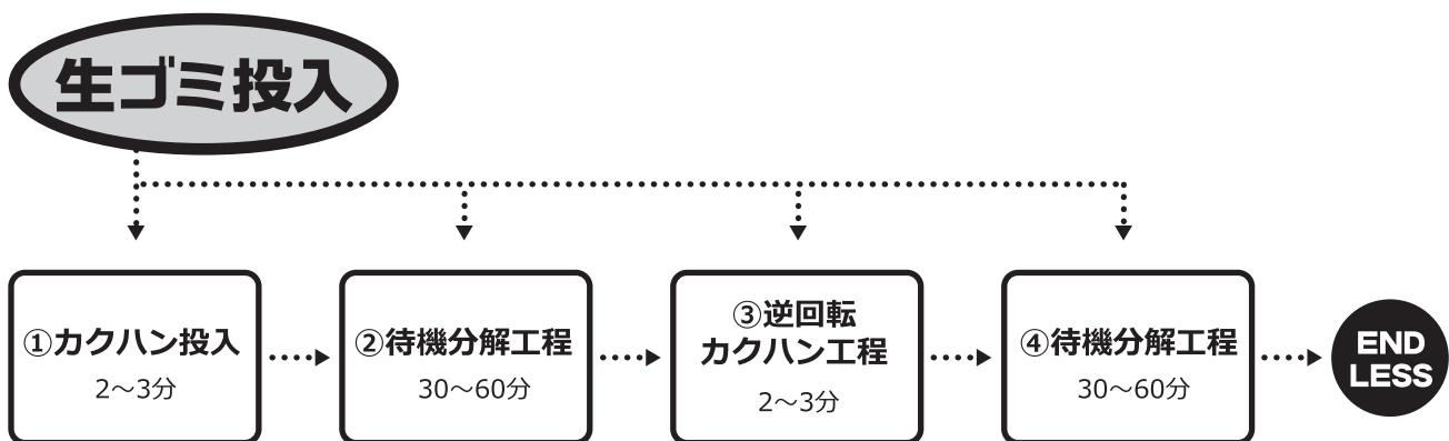
※ディスピーザー稼動時 … 連動、カクハン（稼動停止より120秒まで）
